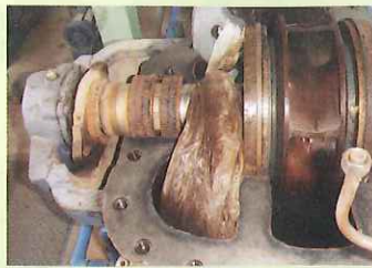
「ポンプ内部に絡みついたハウス用ビニール類」
